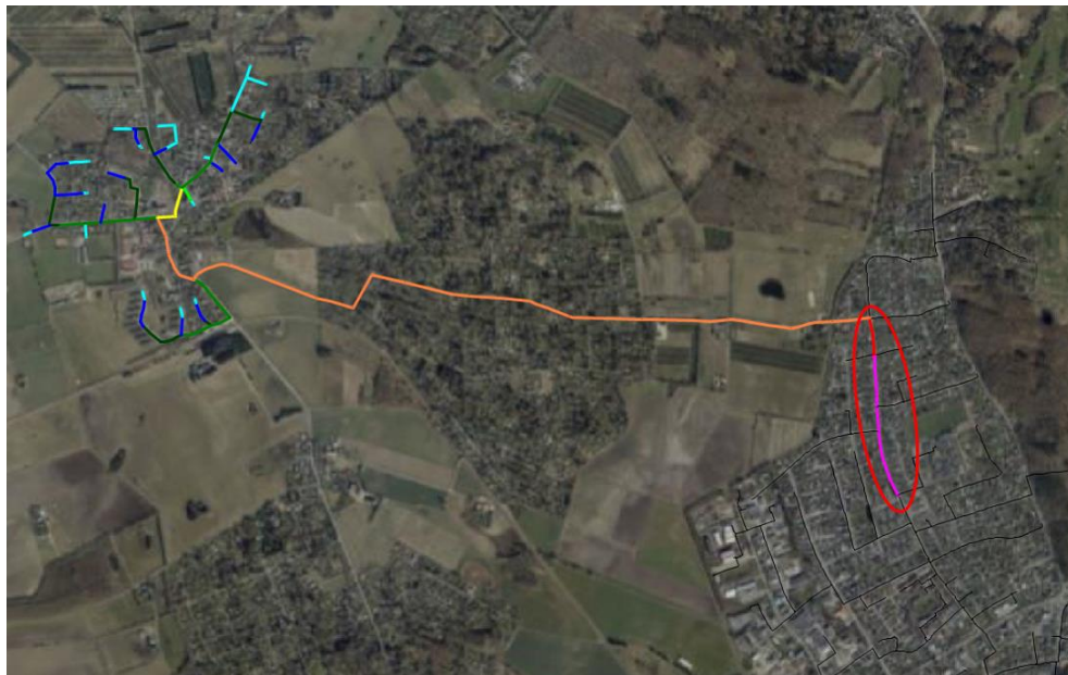
Figur 5-2 Oversigt over det nye ledningsnet
